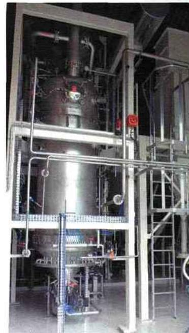
Le réacteur Oxygreen. L'ozone, injecté au bas du réacteur, traverse la masse de grains à traiter, selon un flux ascendant pour un traitement homogène.
